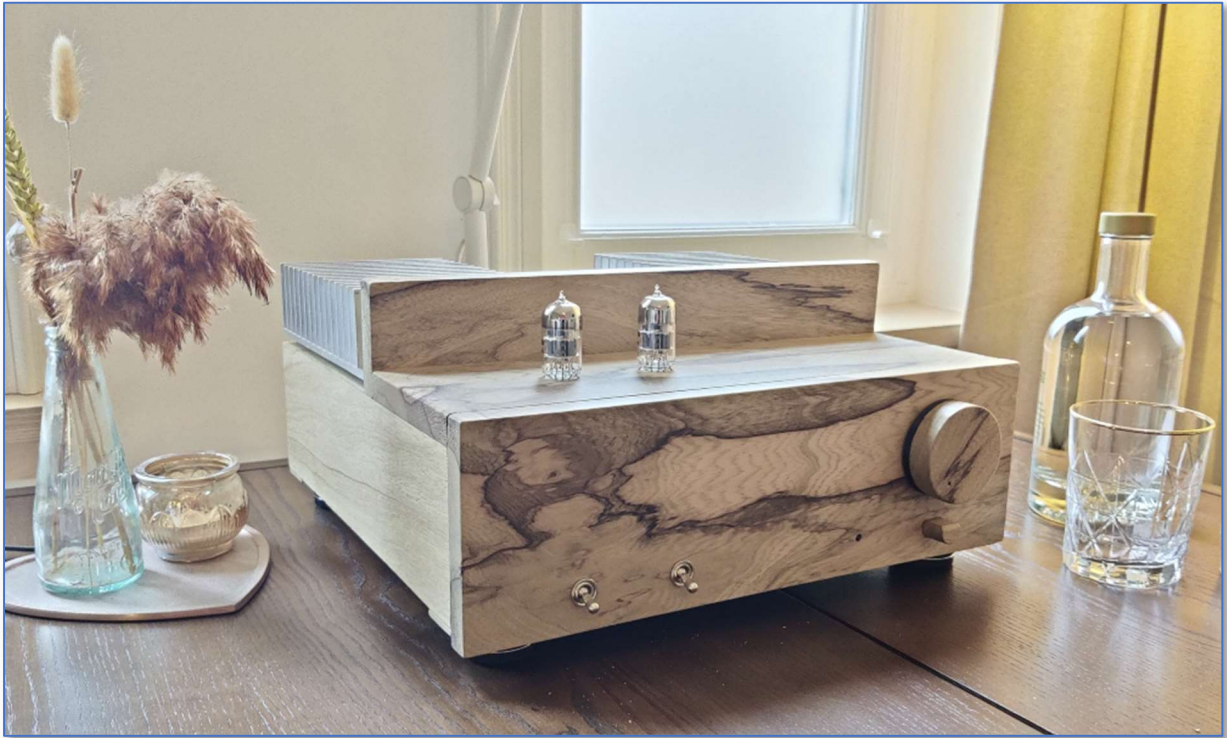
Afbeelding 14: de uiteindelijke versterker. Zwevende koelblokken voor extra goede koeling. Lima als houtsoort.
