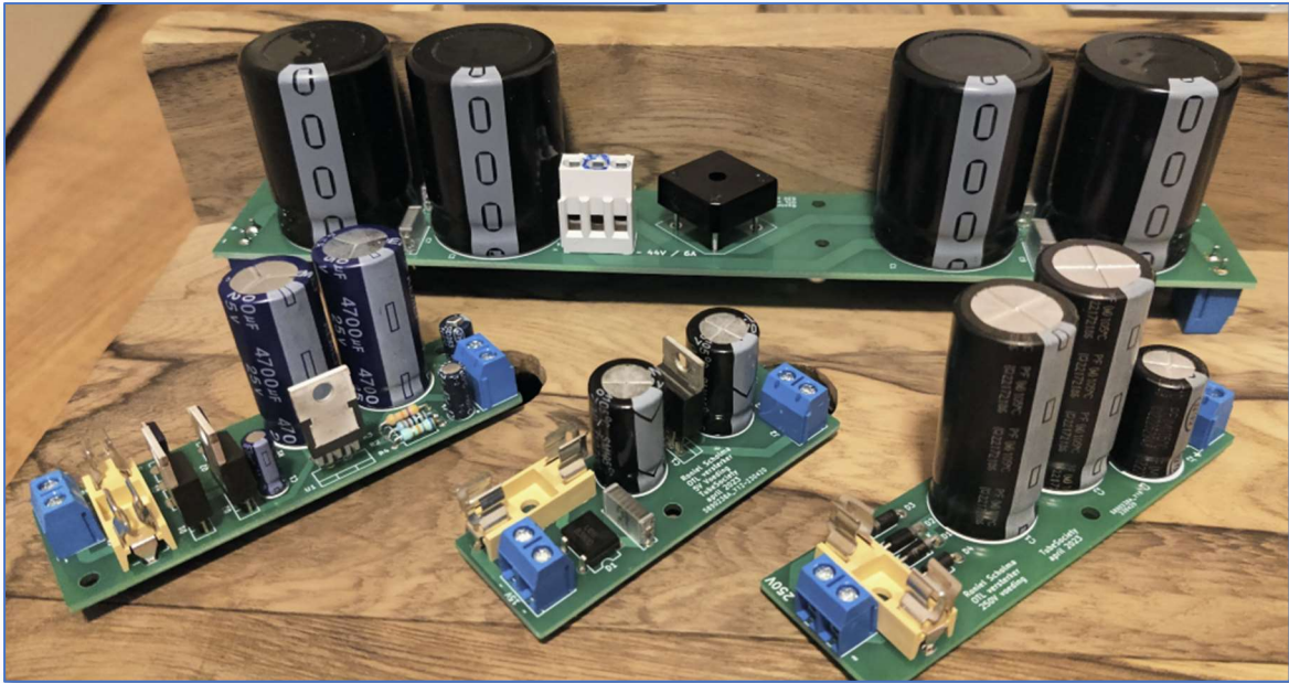
Afbeelding 11: Alle voedingen op de zelfgemaakte printplaten, handig met schroefklemmen en zekeringen
