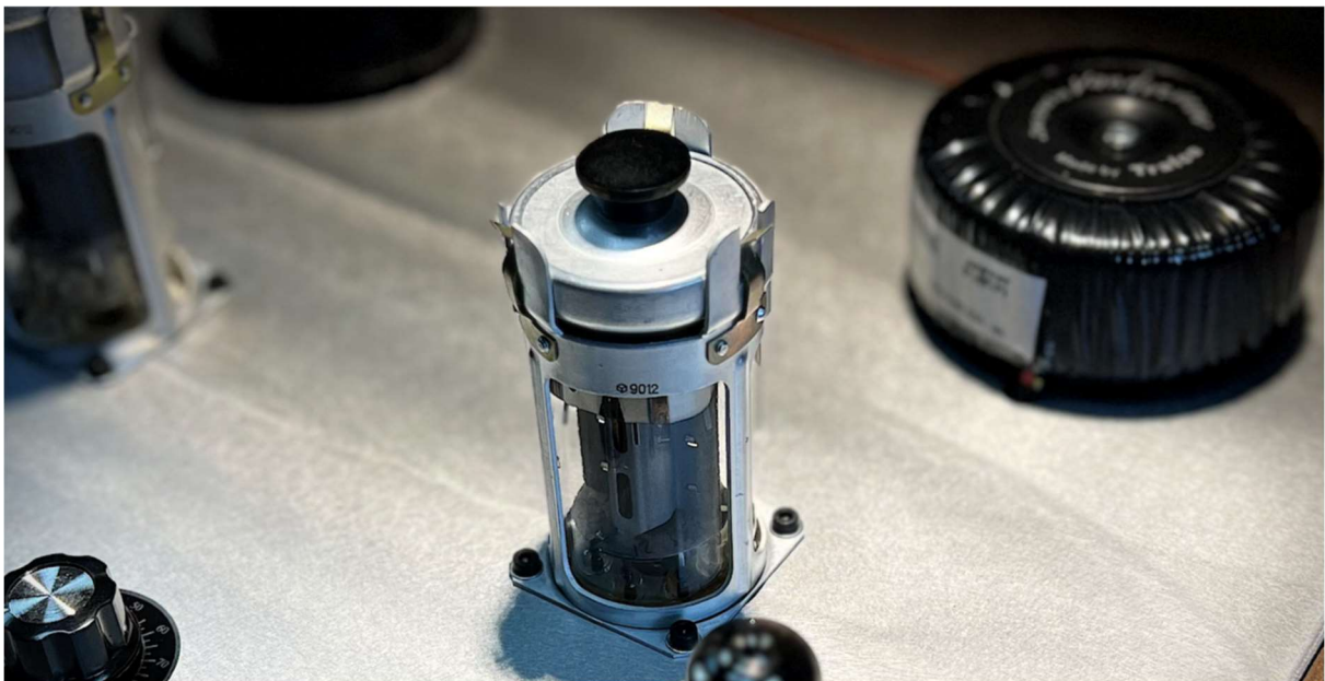
De GU-50 ook wel ru-50. Gemaakt tot 1992 in Rusland. Power Pentode waarvan de grid 2 en grid 3 gekoppeld kunnen worden aan de anode voor Triode-instelling.
