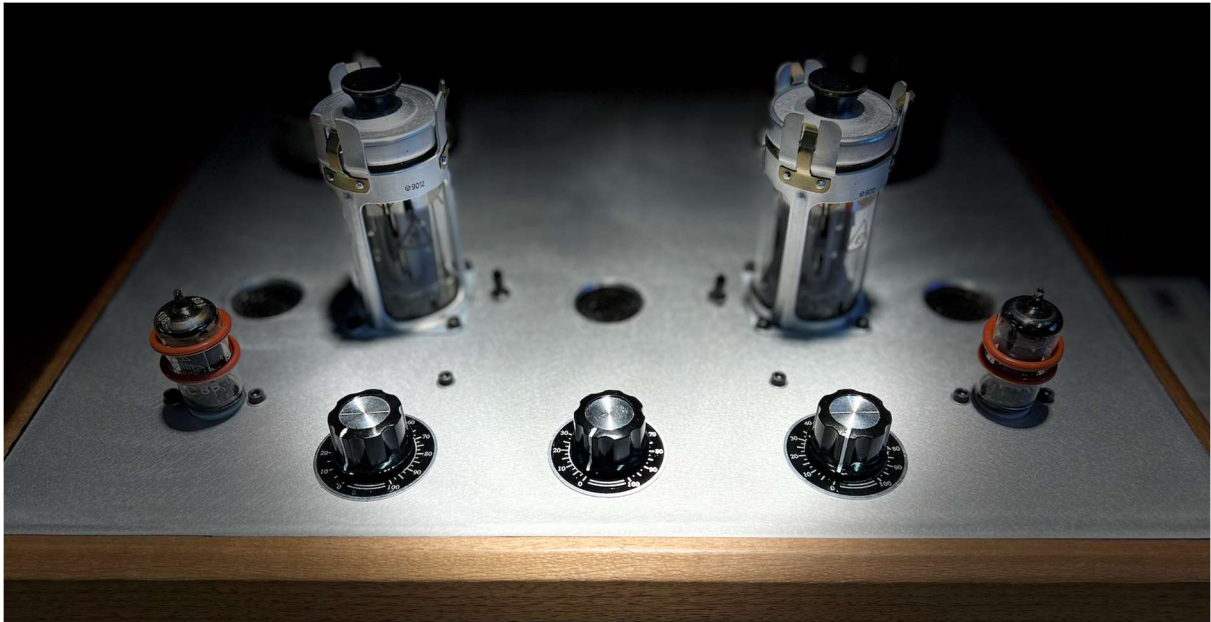
Het eindproduct. Twee enkele triodes Siemens EC88 goldpins, NFB links, Volume midden en rechts drie inputs. Tussen de buizen twee schakelaars. Drie zwarte roosters nodig voor de warmte afvoer.
